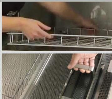
**2 RÉINSTALLEZ LE(S) PANIER(S)-FILTRE(S),** le panier de mise au rebut et le guide du panier nouvellement nettoyés dans la machine et fermez la porte.
