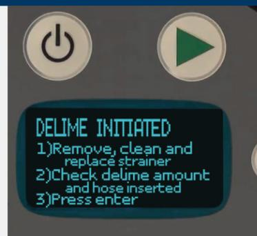
**7 INSPECTEZ L'INTÉRIEUR DE LA MACHINE.** Le cas échéant, un autre cycle de détartrage peut être initié en accédant au **Mode de programmation du gestionnaire** (Répétez les étapes 1 à 4 ci-dessus).
