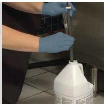
**4 ⚠️ DÉSACTIVEZ LE SYSTÈME CHIMIQUE D'ALIMENTATION** en détergent conformément aux recommandations du fabricant du produit. Ceci réduira le besoin d'ajouter du détergent pendant l'opération de détartrage.
